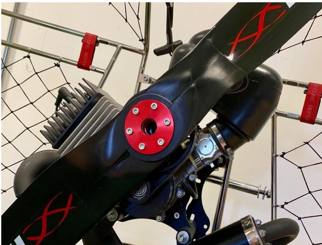
En caso de impacto de la hélice, es necesario verificar que todas las piezas del motor no hayan sufrido ningún daño, prestando especial atención a los componentes que se enumeran a continuación: Polea de reducción y rodamientos; Reducción excéntrica; el cárter y el cigüeñal del motor, el soporte del cárter y los soportes de goma del motor.
